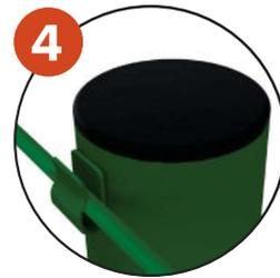
**4** Sur les poteaux intermédiaires, des crochets rigides et légèrement ouverts, permettent de passer le câble, en évitant que celui-ci ne ressorte suite à un coup de vent
